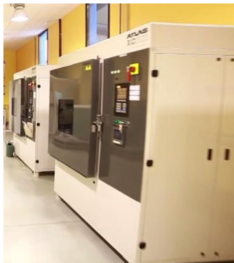
Figura 2: Câmaras de envelhecimento climático para fazer ensaios classe 1-método 1 sob a norma EN50483.
